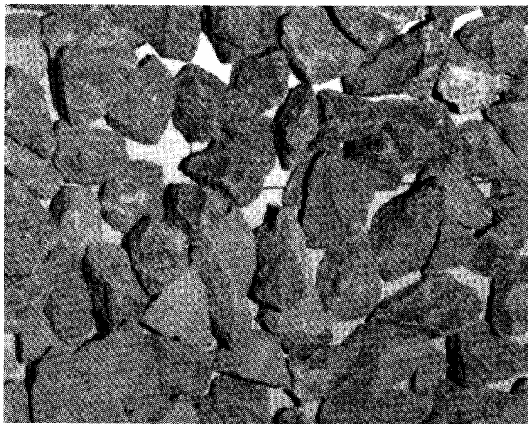
دانه‌بندی ۱۰/۱۴، مقدار مصرفی ۱۰ لیتر بر متر مربع، مقیاس ۱:۱
